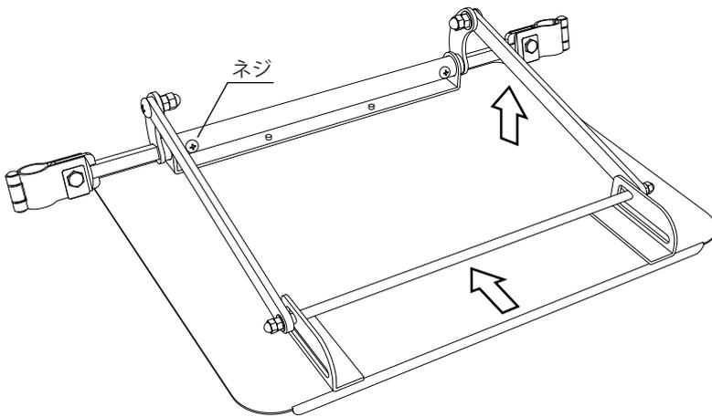
・始めに、左の図のように裏面にし、スライドさせてネジが見えるようにして下さい。
